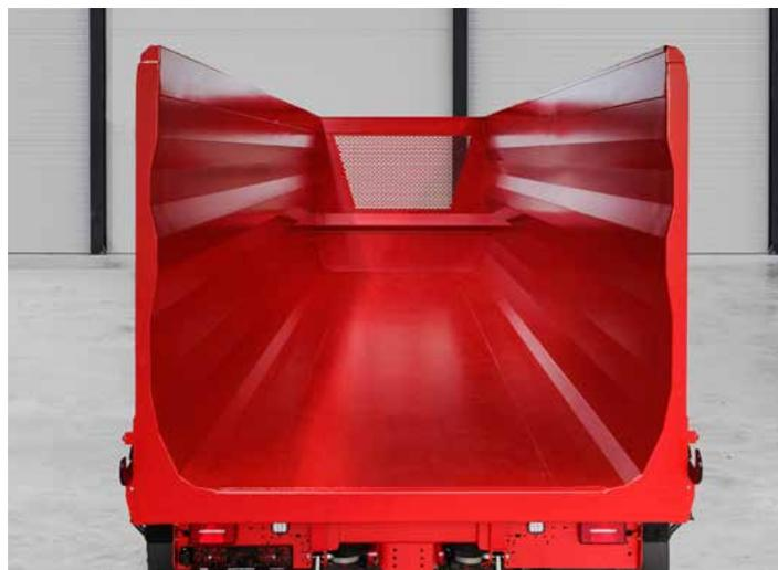
Construction de la caisse de 2 m de hauteur - étanche aux grains et stable.
